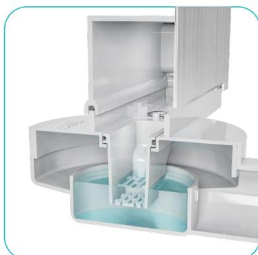
Anti-odeur: avec la garde d'eau et joint torique.
