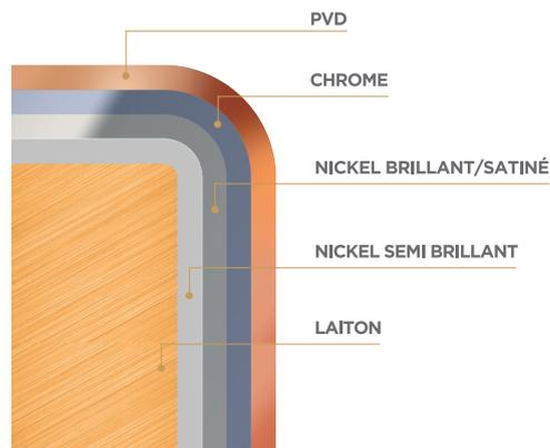
Le revêtement PVD est un traitement de surface qui se déroule dans une chambre sous vide. La combinaison de métaux purs avec des gaz réactifs procure à la surface déjà chromée au préalable une couleur, une finition et une durabilité exceptionnelles. La surface traitée en PVD est plus endurante, plus résistante à la corrosion, aux rayures ainsi qu'au sel de l'air marin.
